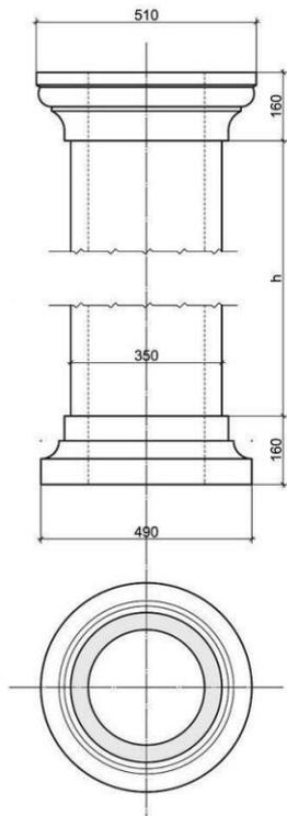
Колонна KN-02, канелированная
